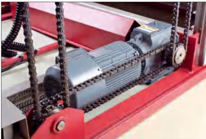
功率强大高效的电机允许升降机达到 2.30 m/sec 行驶速度
