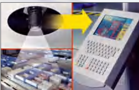
拍照物品并直接在控制单元上显示照片
