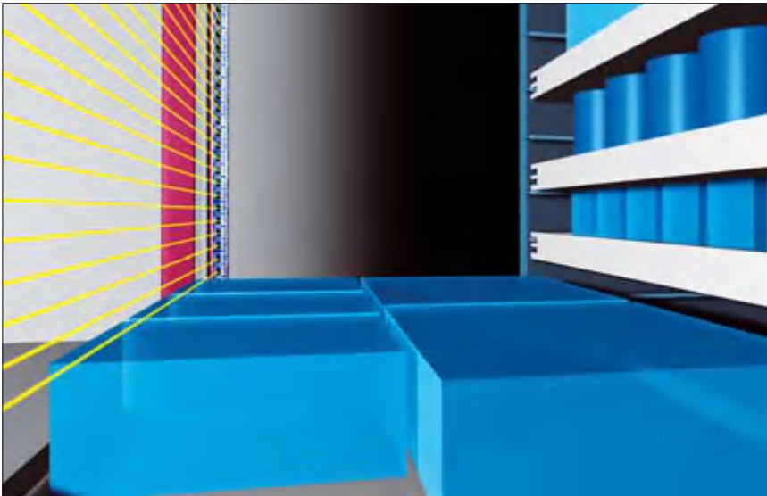
仓储的物品在存取点由高度传感器测量
