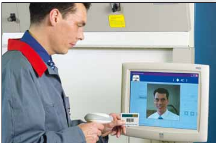
通过 ID 卡、PIN 码或 RFID 感应器进行用户验证
