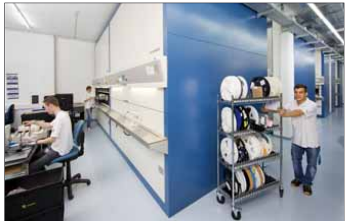
PC 板组件的 ESD 缓冲仓储区
