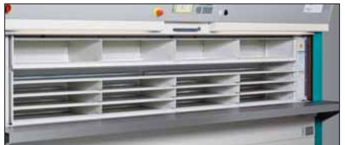
具有水平存放隔板并在每层配置移动分隔件的多功能托盘
