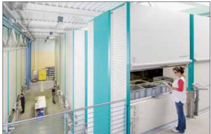
根据 Hänel Lean-Lifts® 的高度，存取点可以安装在不同楼层。多人可以在不同位置和楼层同时使用 Hänel Lean-Lift®
