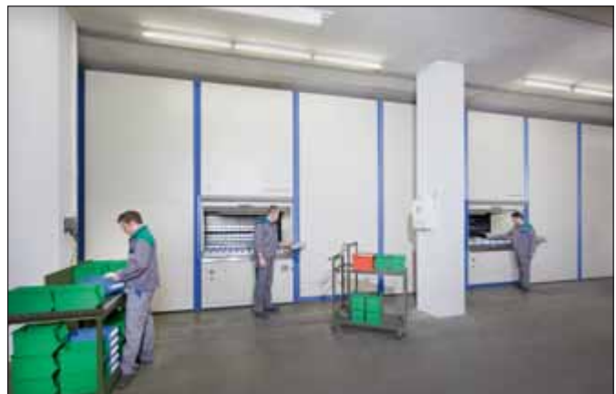
两个 Hänel Multi-Space® 装置，每个宽 9.57 m 组成生产车间的中央仓储区
